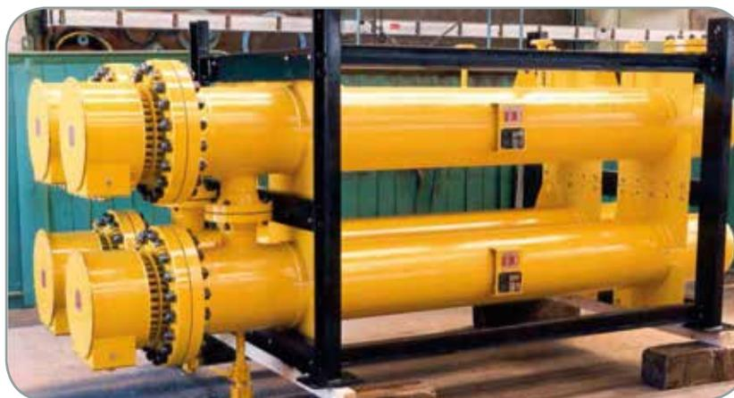
Batterie pour chauffage de locaux de stockage de produits sensibles sur site pétrochimique
