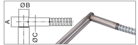
Sortie perpendiculaire avec tube
