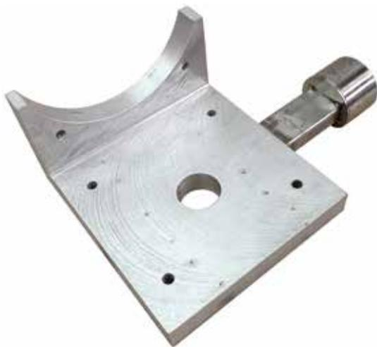
Les plateaux et colliers chauffants surmoulés sont composés d'une ou plusieurs résistances électriques chauffantes noyées dans un alliage de type aluminium, laiton, bronze ou cupronickel possédant une excellente conductivité thermique.
