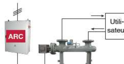
Réseau à forte inertie (boucle fermée) Ex : réseau chauffage eau, fluide thermique
